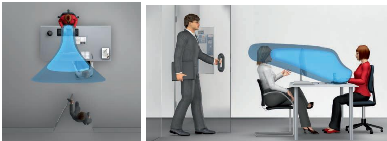
Kuva 5: Rakenneversio PC, jossa painotus on välinäköalueella.
