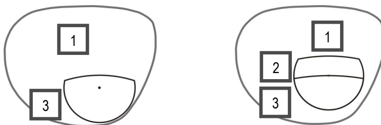
Figura 2: Structura unei lentile bifocale (stânga) și a unei lentile trifocale (dreapta)
