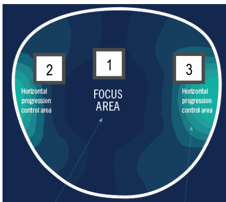
1. kép: A MyCon lencse sematikus felépítése
