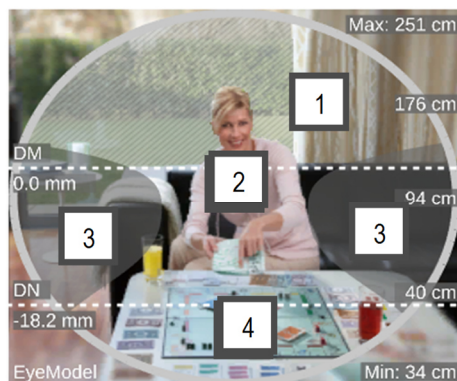
Figure 1: Structure schématique d'un verre de proximité Les zones rayées ne sont pas clairement visibles.
